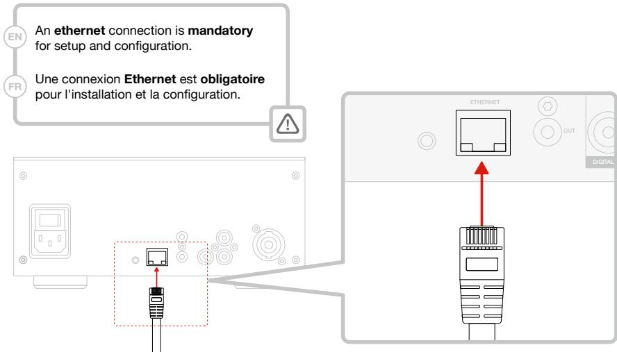
**DE** Für die Einrichtung und Konfiguration ist eine **Ethernet-Verbindung** erforderlich.
